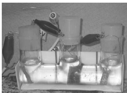
図2 Li インターカレーションセルの様子
