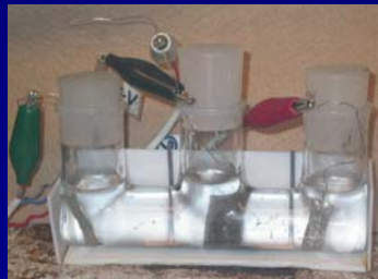
電気化学的Liインターカレーション用セル。
